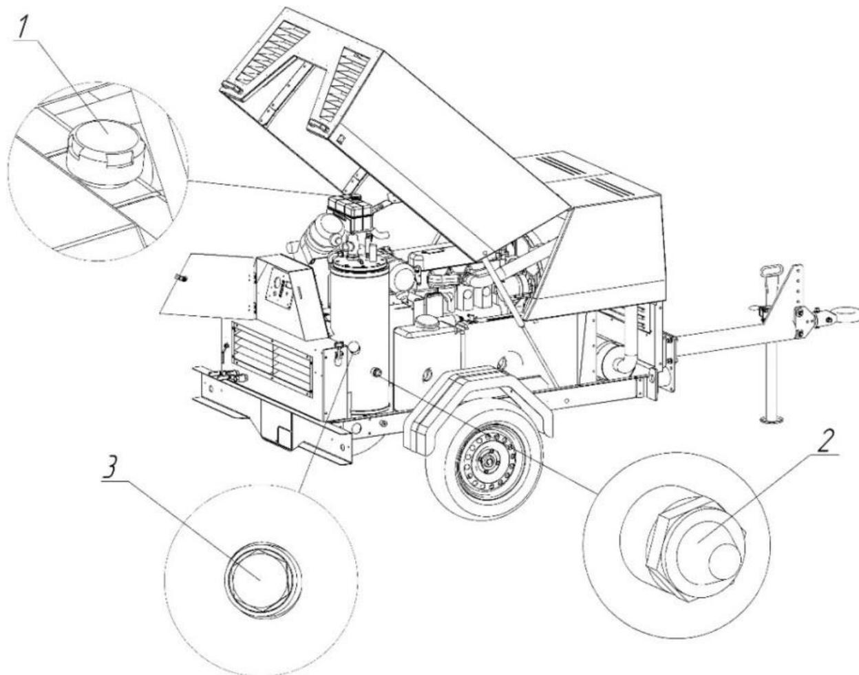
1 – Заливная горловина расширительного бачка
